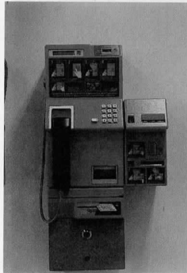
Rotor 2 dotato di lettori per carte prepagate (a destra) e per carta di credito telefonica (sotto) - 1988
