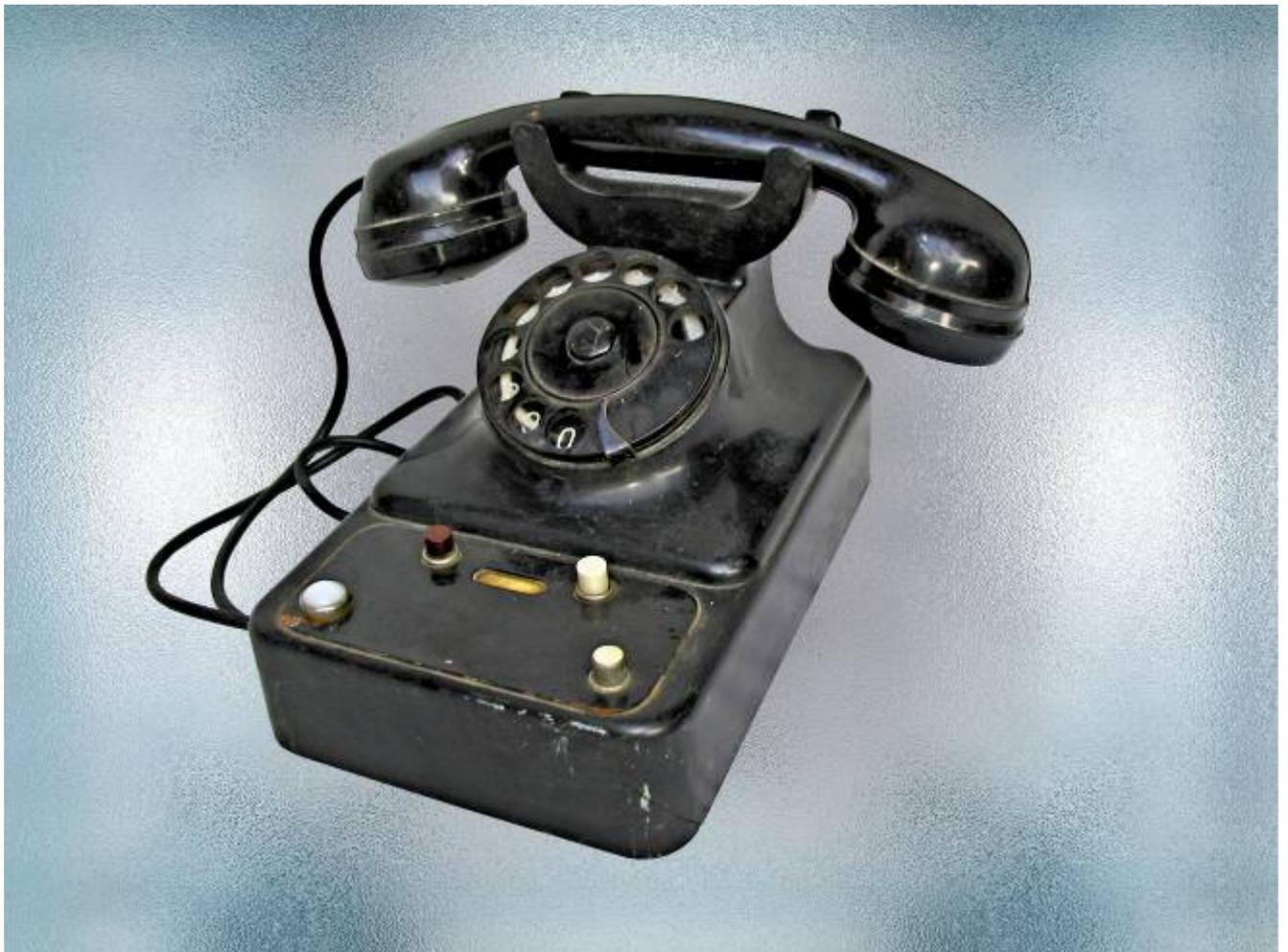
Telefono in metallo della ditta SIEMENS a una linea intercomunicante con un interno (1+1).
